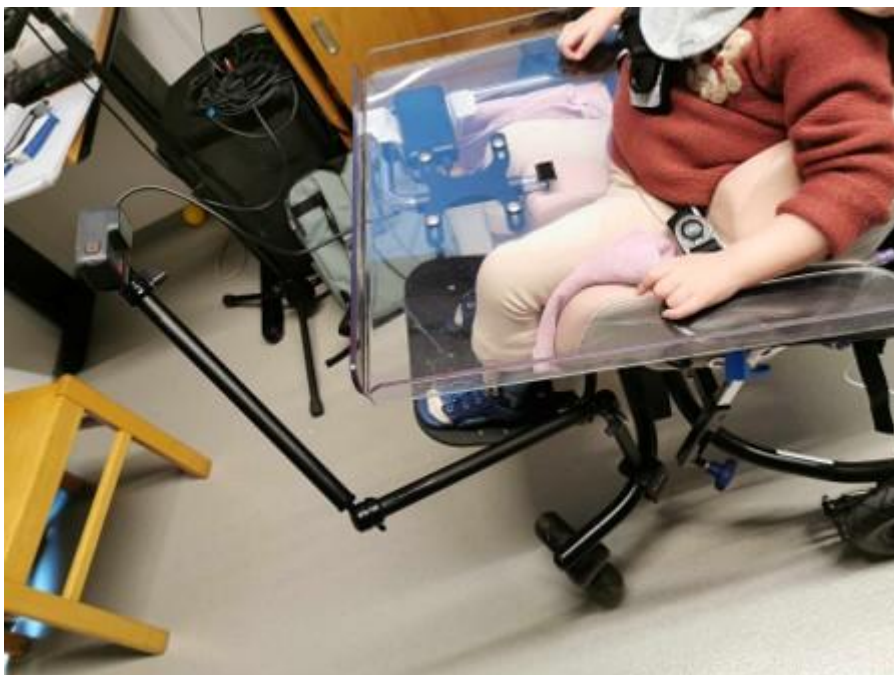
Figuur 2. Opstelling van de 2D-camera aan de voorzijde van de rolstoel
