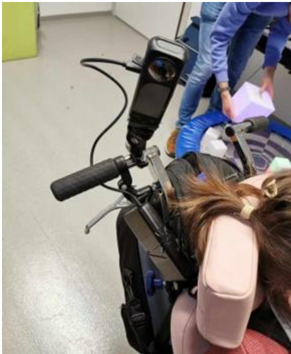
Figuur 3. Opstelling van de 360°-camera aan de achterzijde van de rolstoel
